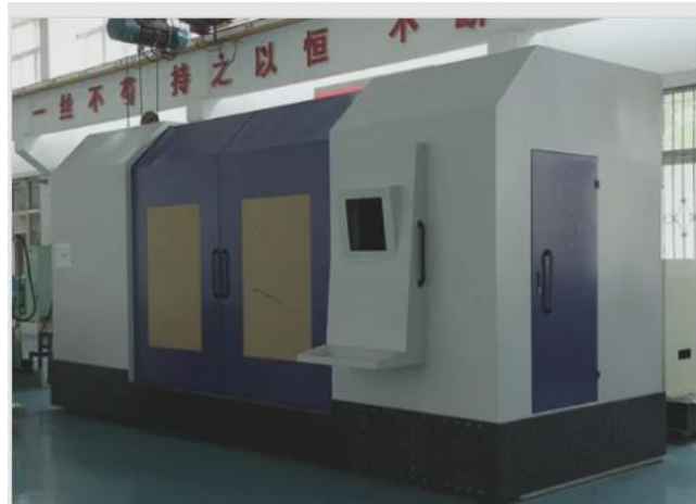
Рис. 2.1. Комплекс на базі CO 2 -лазера для поверхневого зміцнення
