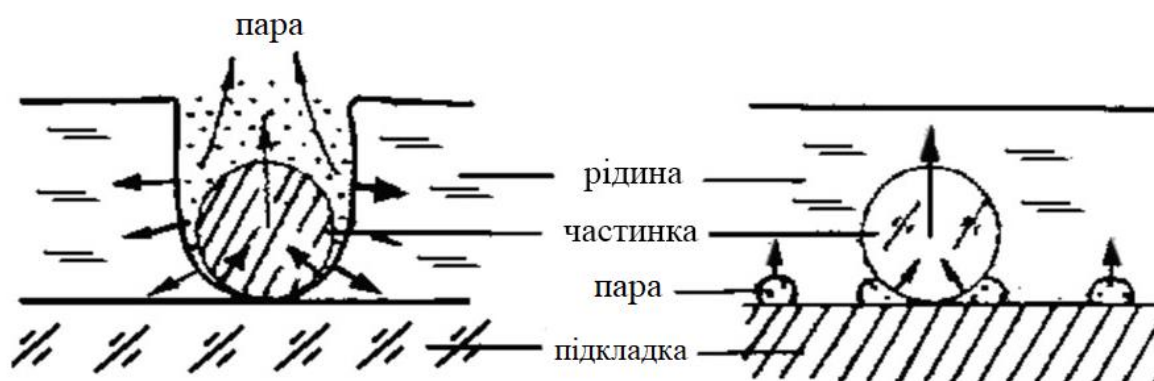
Рис 4.6. Ілюстрація фізичних механізмів вологого очищення поверхні: а – поглинання випромінювання часткою; б – поглинання випромінювання підкладкою
