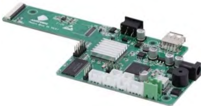
Рисунок 1.23 – Плата керування, яка є аналогом мікрокомп'ютера Raspberry
