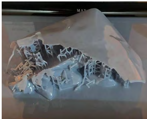
Рисунок 2.3 – Відшарування базових шарів від платформи
