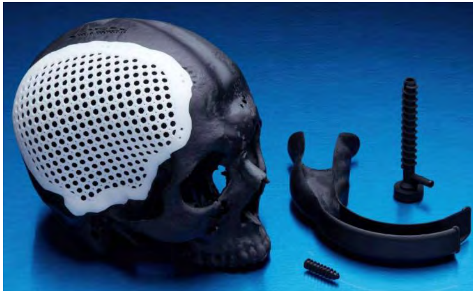
Рисунок 1.30 – Деталь виготовлена з біосумісного фотополімера
