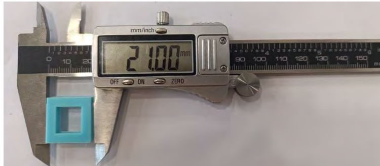
Рисунок 2.33 – Вимірювання розмірів відхилення базових шарів
