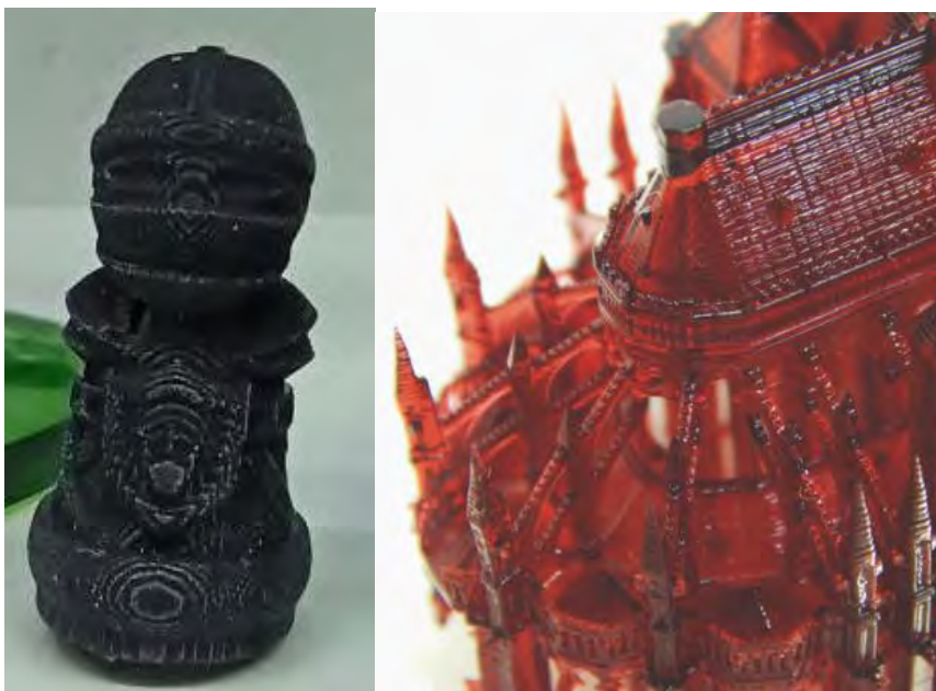
Рисунок 1.14 – Порівняння надрукованих деталей з використанням екранів з розміром пікселя 100 мкм і 45 мкм
