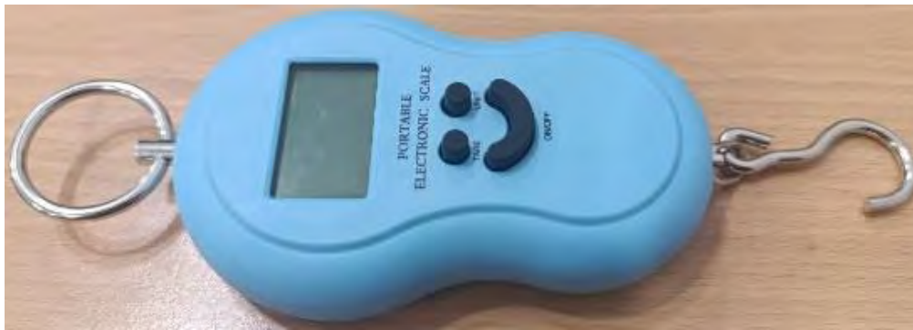
Рисунок 4.4 – Ваги для вимірювання сили відриву
