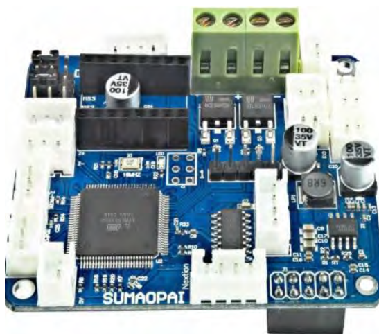
Рисунок 1.70 – Плата керування периферією NanoDLP
