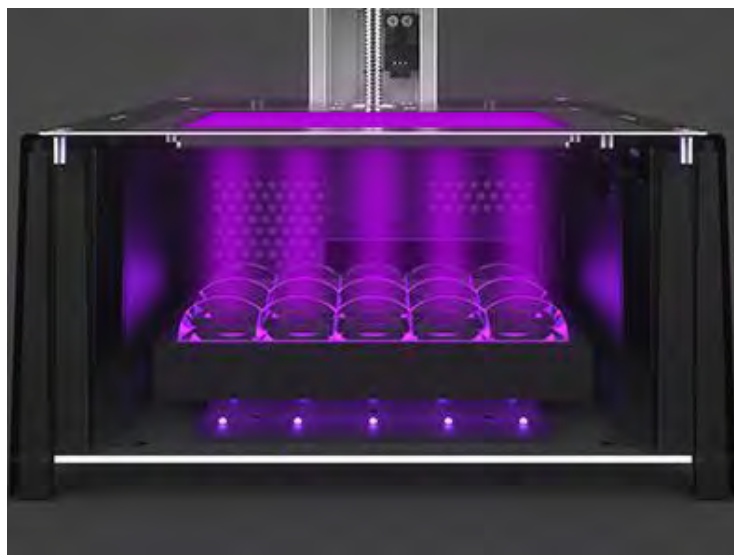
Рисунок 1.16 – Світлодіодна матриця в складі принтера
