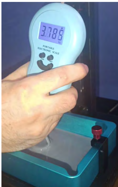
Рисунок 4.5 – Забір сили відриву експонованого шару від плівки
