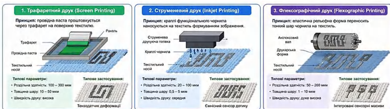
Рисунок 2 – Методи друку в друкованій електроніці для текстильних сенсорних систем
