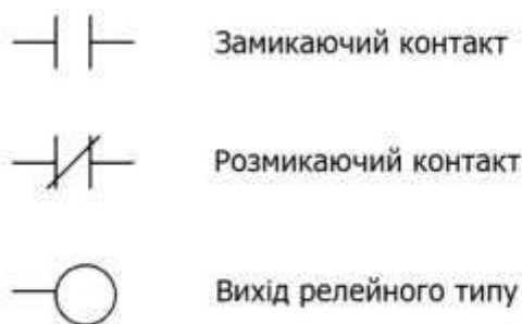
Рисунок 3.12 – Основні елементи релейно-контактних схем
