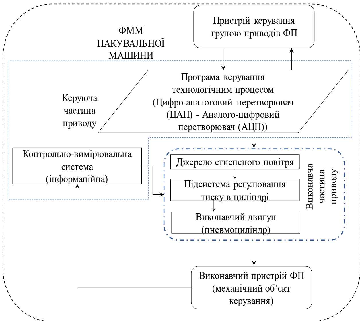
Рисунок 4.19 – Структура електропневматичного дослідного приводу з мехатронною складовою
