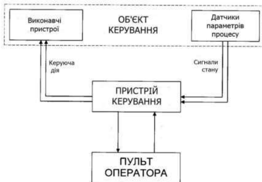
Рисунок 3.7 – Структурна схема автоматизованої системи управління автономним об'єктом
