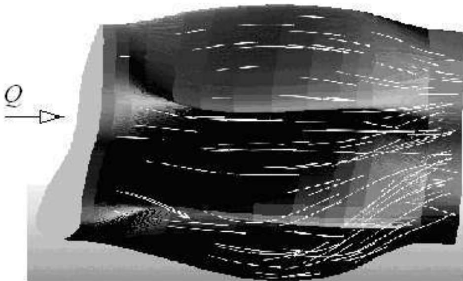
Рис. 5.3. Ілюстрація розподілу швидкостей уздовж носового ходу (по густоті ліній повітряного потоку) за даними чисельного експерименту в пакеті FlowVision
