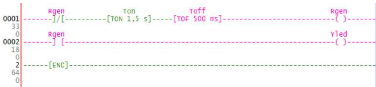
Рисунок 5.25 – Приклад програми, що відповідає часовій діаграмі з рис. 5.24
