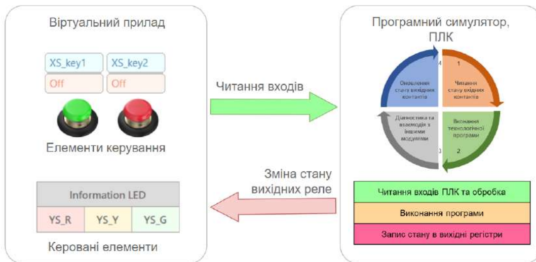
Рисунок 3.17 – Принцип взаємодії віртуального приладу і програмного симулятора ПЛК
