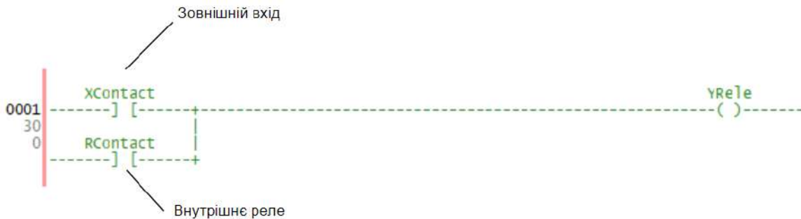
Рисунок 4.3 – Зовнішні та внутрішні джерела сигналів
