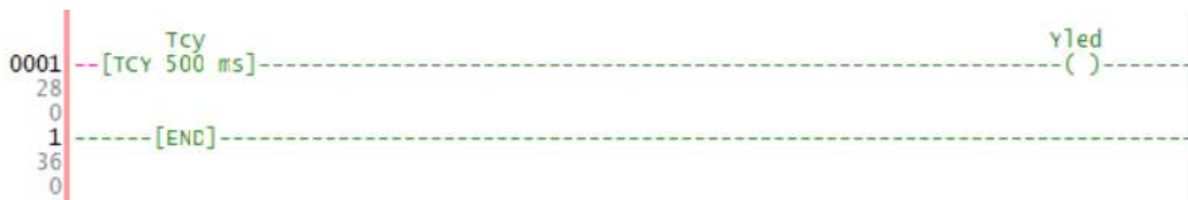
Рисунок 5.28 – Приклад застосування циклічного таймеру ТСУ для організації блимання світлодіоду
