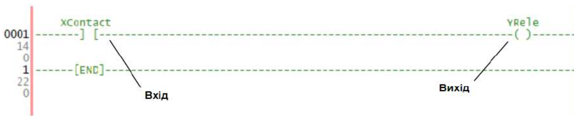
Рисунок 4.2 – Приклад простої LD-діаграми
