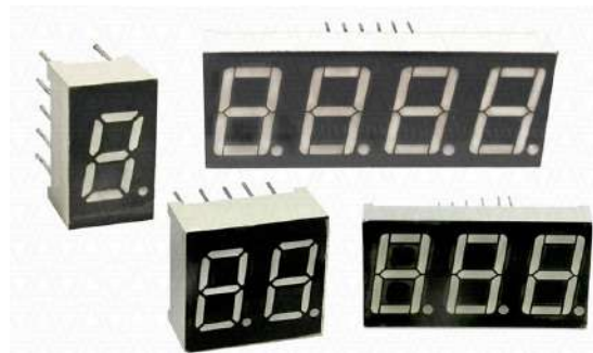
Рисунок 6.10 – Світлодіодні модулі із різною кількістю розрядів
