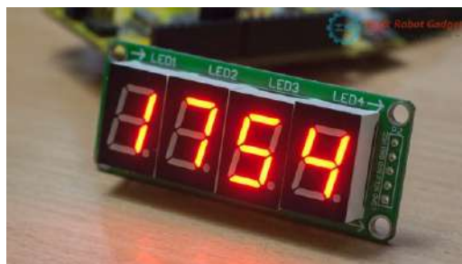
Рисунок 6.1 – Приклад виведення цифр на табло із чотирьох семисегментних індикаторів
