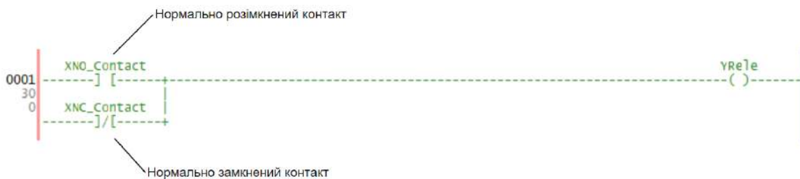
Рисунок 4.6 – Приклад використання нормально розімкнених та нормально замкнених контактів
