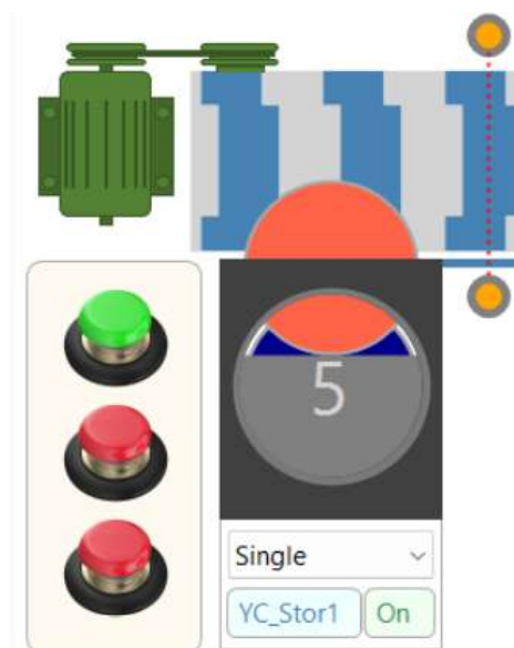
Рисунок 3.25 – Виштовхування деталі з магазину на конвеєр
