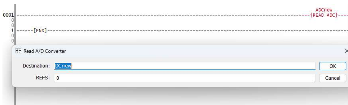
Рисунок 6.26 – Використання інструкції «Read A/D Converter»
