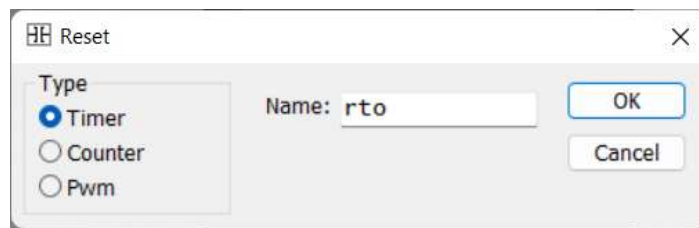
Рисунок 5.16 – Налаштування параметрів інструкції скидання RES
