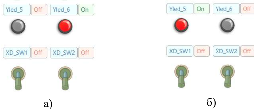
Рисунок 4.55 – Фіксація попереднього стійкого стану роботи RS-тригера
