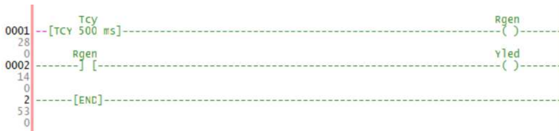
Рисунок 5.26 – Приклад програми з використанням таймеру ТСУ для генерації імпульсів заданої частоти
