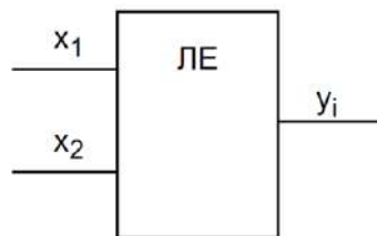
Рисунок 4.11 – Логічний елемент з двома вхідними сигналами x_1 і x_2 і одним виходом y_i
