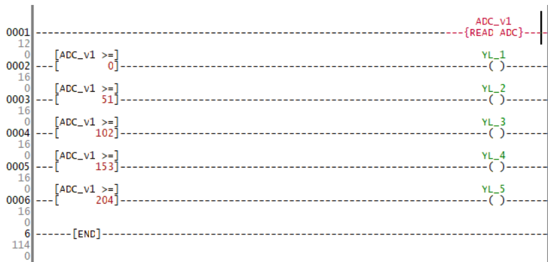
Рисунок 6.30 – Діаграма LD для індикації рівня сигналу за отриманим значенням від АЦП
