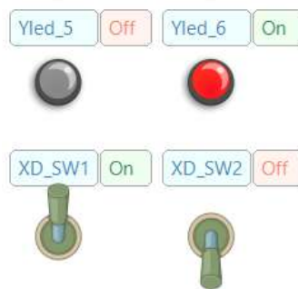
Рисунок 4.51 – Режим роботи RS-тригеру, коли на вході R знаходиться логічна одиниця, а на вході S – логічний нуль
