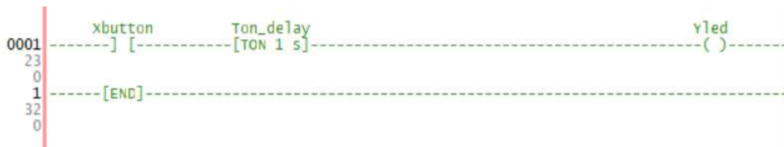
Рисунок 5.4 – Приклад використання інструкції TON в програмі
