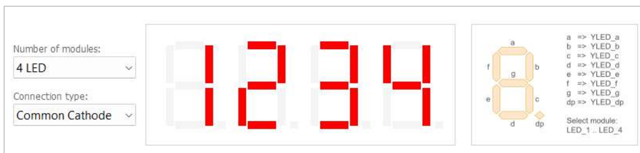
Рисунок 6.25 – Приклад виведення числа «1234» на чотирьохрозрядний індикатор в віртуальному макеті
