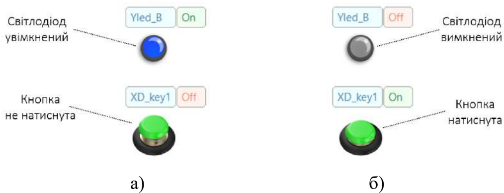
Рисунок 4.27 – Приклад роботи схеми логічного елемента НІ
