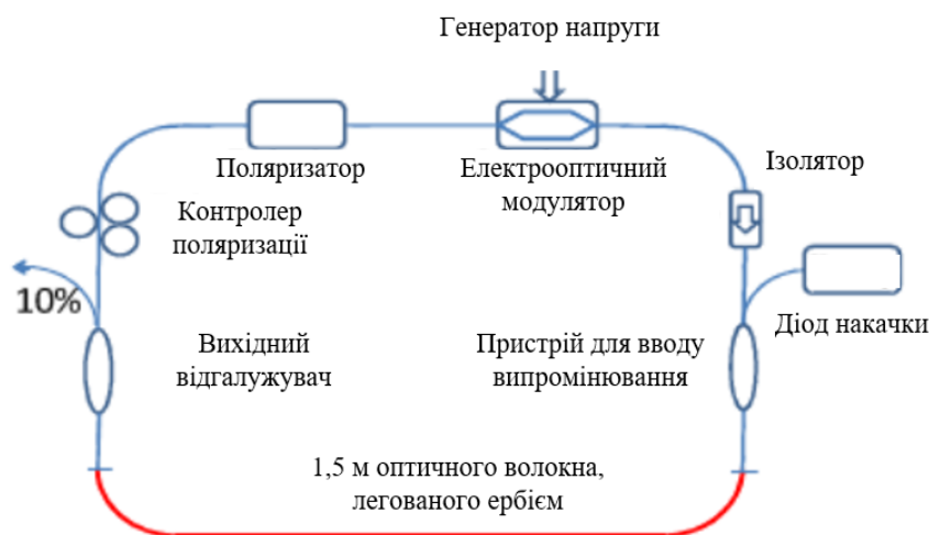
Рисунок 1.15 – Кільцевий волоконний лазер з активною синхронізацією мод
