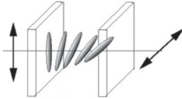
Рисунок 3.17 – Схема зміни орієнтації молекул РК при прикладанні електричного поля до twist -комірки
