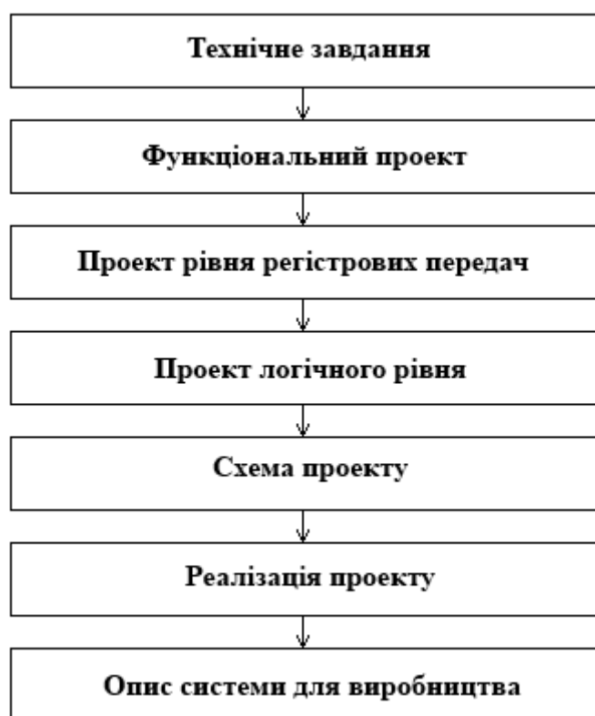
Рисунок 1.12 – Етапи системного проектування цифрових пристроїв
