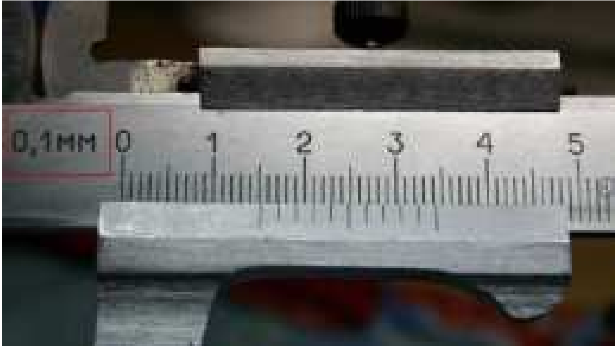
Рисунок 21 – Приклад зчитування результатів вимірювання штангенциркулем
