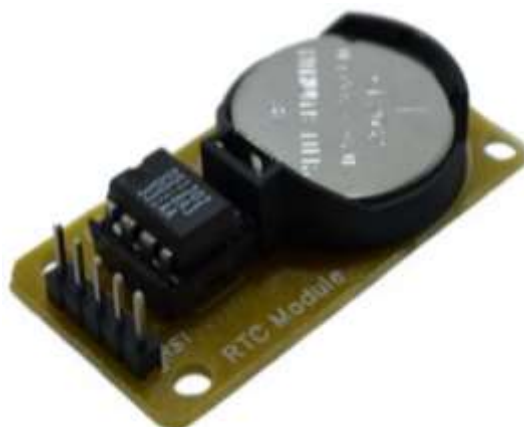
Рисунок 3.62 – Модуль годинника реального часу
