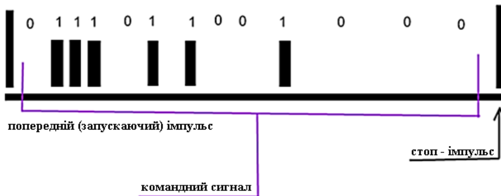
Рисунок 2.6 – Система кодувань пульта дистанційного керування
