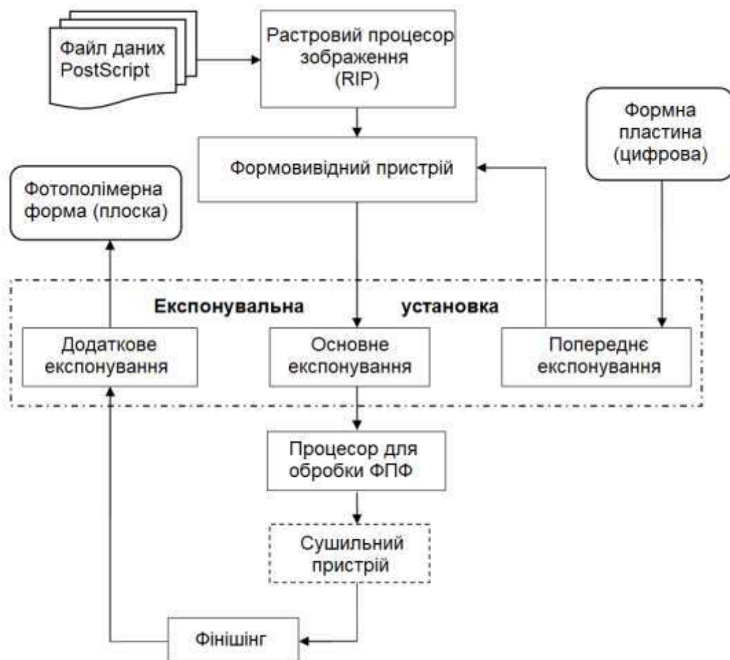
Рисунок 1.15 – Схема процесу виготовлення плоских фотополімерних флексографічних друкарських форм методом лазерної абляції
