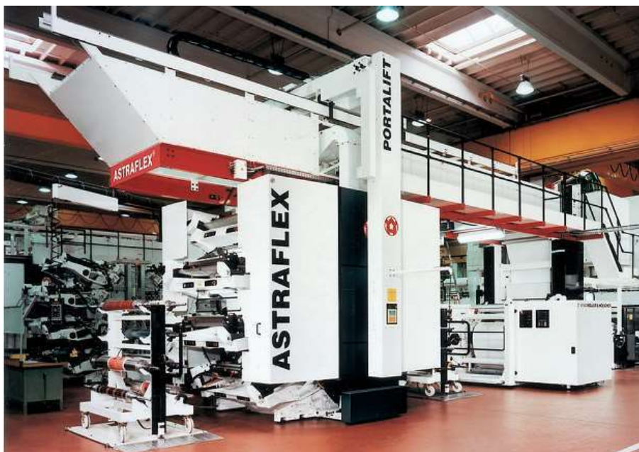
Рисунок 2.5 – Флексографічна друкарська машина планетарної побудови з вісьмома друкарськими апаратами (Astraflex. W&H)
