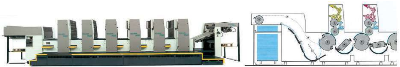
Рисунок 2.9 – Roland 700, шестифарбова машина: формат 740×1040 мм, швидкість друкування 15 000 відб./год (MAN Roland)
