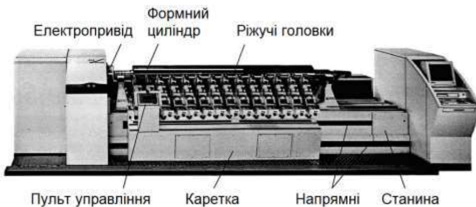
Рисунок 1.20 – Електронно-механічний гравіювальний автомат для виготовлення форм глибокого друку
