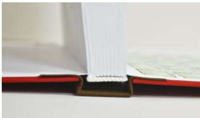
Рисунок 3.64 – Палітурка типу 8: 1 – картонна сторонка, 2 – блок, 3 – форзац [38]
