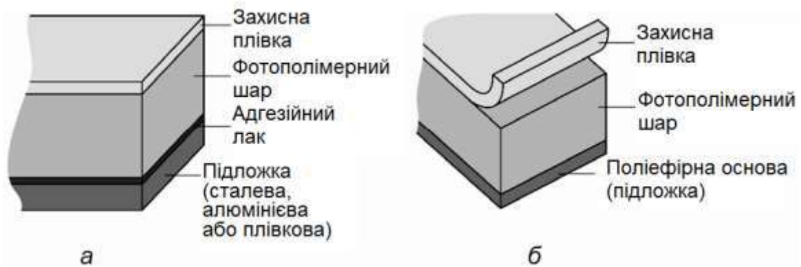
Рисунок 1.13 – Структура фотополімеризованих пластин: а – для типографського друку; б – для флексографічного друку
