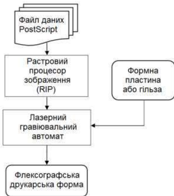
Рисунок 1.16 – Схема технологічного процесу виготовлення флексографічних друкарських форм за технологією прямого лазерного гравіювання
