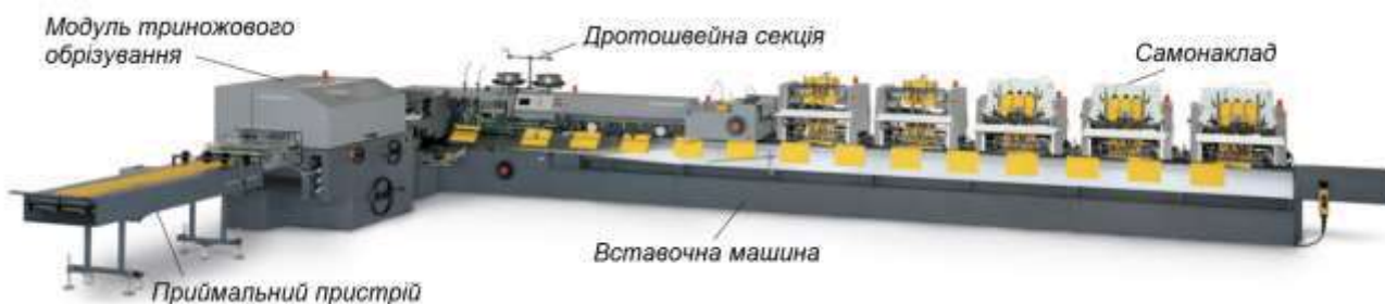
Рисунок 3.19 – Вкладально-швейно-різальний агрегат для виробництва брошур, що комплектуються вкладкою (Кіпхан)
