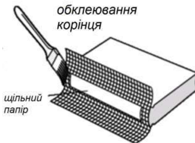
Рисунок 3.45 – Схема обклеювання корінця для підвищення міцності
