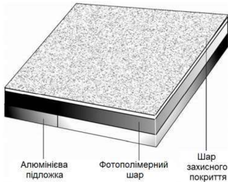
Рисунок 1.7 – Структура фотополімеризованої пластини для прямого запису зображення під час виготовлення офсетної форми
