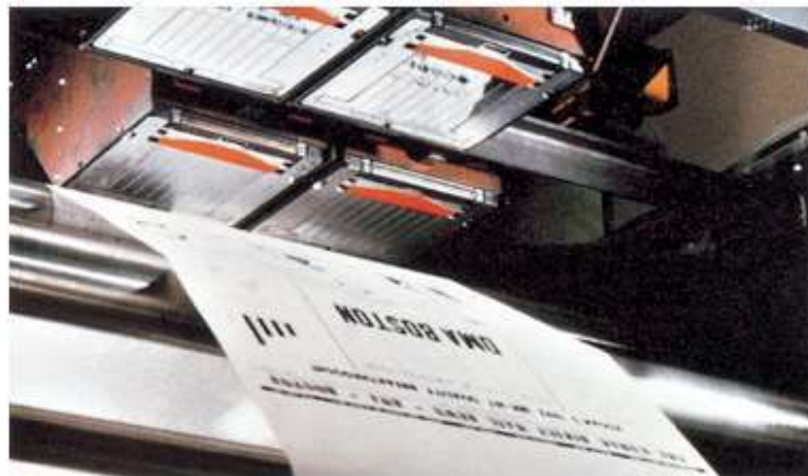
Рисунок 2.19 – Високоякісна система струменевого друку на рулонному матеріалі: а) установка з чотирма друкуючими головками (240 dpi, швидкість полотна до 2 м/с); б) головка для струменевого друку з сопловою системою (система 3600, Scitex Digital Printing)
