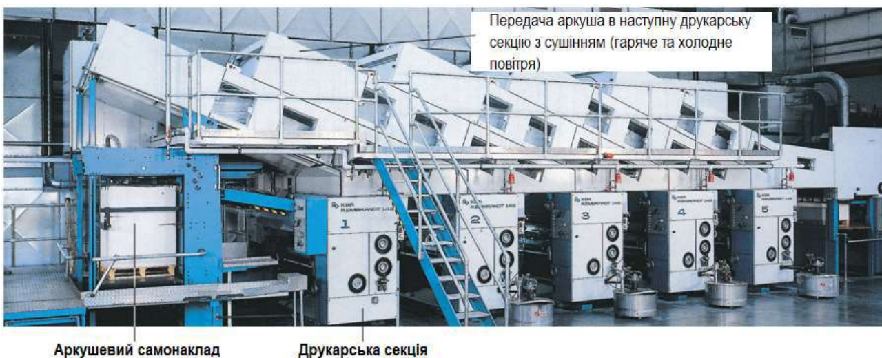
Рисунок 2.13 – Багатофарбова машина аркушевого глибокого друку на пакуванні (Rembrandt 142, КВА)
