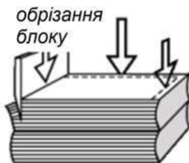
Рисунок 3.41 – Схема виконання обрізання блоку з трьох сторін
