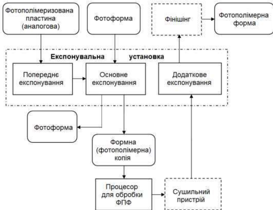
Рисунок 1.14 – Схема процесу виготовлення фотополімерних форм за технологією «комп'ютер – фотоформа» (Computer-to-Film – CTF)
