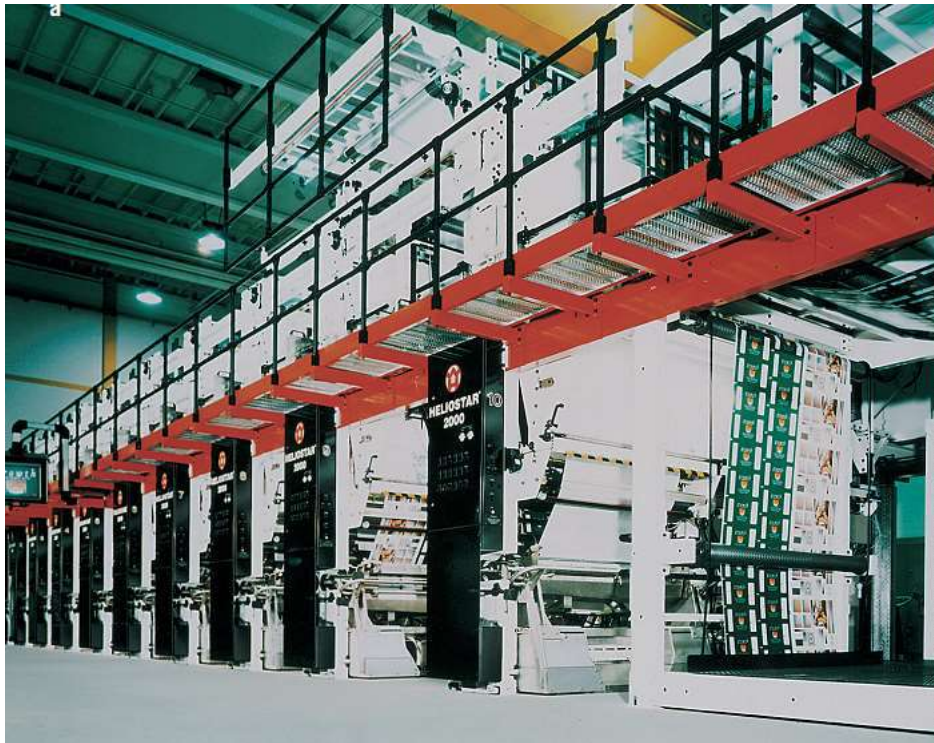
Рисунок 2.12 – Рулонна друкарська машина глибокого друку на пакуванні (10 друкарських секцій)
