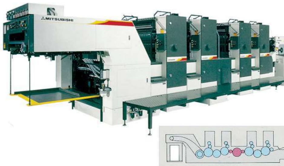
Рисунок 2.10 – Модель 3FR– 4, чотирифарбова машина з перевертанням аркуша 2/2 формату 720×1020 мм, швидкість друкування 13000/11000 відб./год (зменшена швидкість під час друкування з оборотом) (Mitsubishi)
