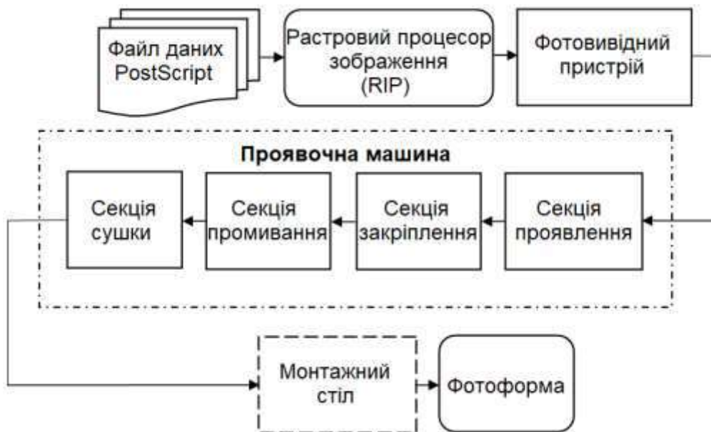
Рисунок 1.2 – Схема процесу виготовлення фотоформ
