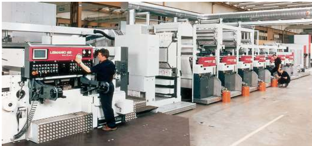
Рисунок 2.6 – Секційна флексографічна друкарська машина з інтегрованим висічним пристроєм для виготовлення картонних коробок (друкування на рулонному матеріалі, виведення висіченого аркуша) (LEMATIC 82F, Bobst)
