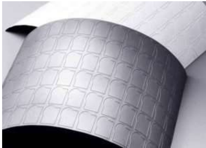
Рисунок 3.103 – Гнучкий висічний штамп [46]
