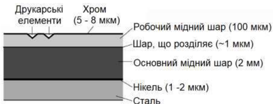
Рисунок 1.18 – Структура поверхні форми глибокого друку
