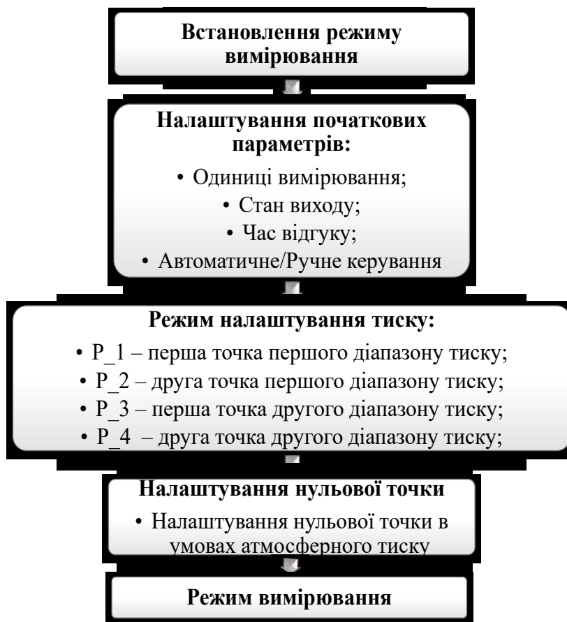
Рисунок 2.15 – Алгоритм налаштування електронного реле вакууму / тиску
