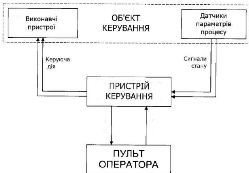
Рисунок 3.7 – Структурна схема автоматизованої системи управління автономним об'єктом
