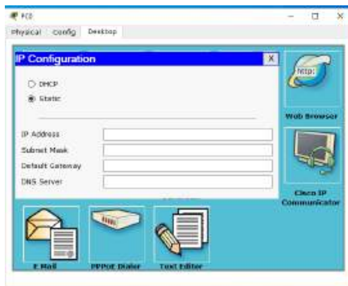
Рисунок 8.19 – Вікно адресації кінцевого пристрою
