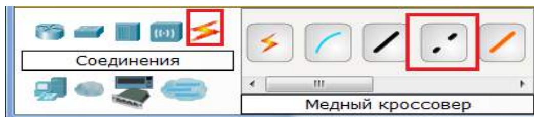
Рисунок 8.31 – Вибір типу кабелю «мідний кросовер»
