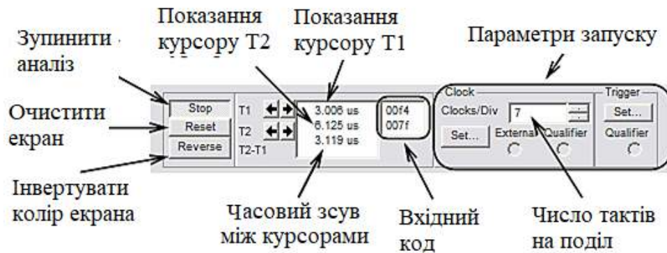
Рисунок 6.74 – Панель керування логічного аналізатора
