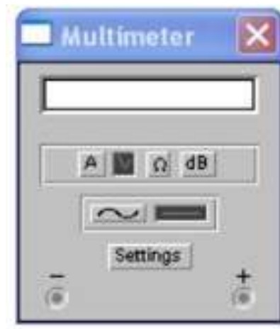
Рисунок 6.37 – Лицьова панель мультиметра
