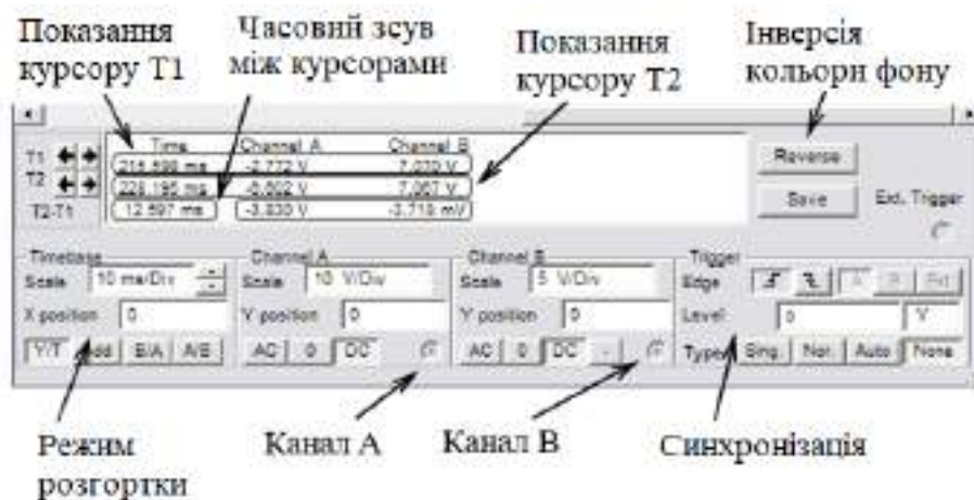
Рисунок 6.63 – Панель керування осцилографом
