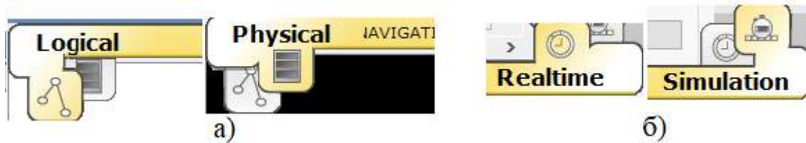
Рисунок 8.3 – Перемикачі режимів робочої області:
