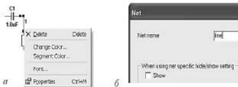
Рисунок 6.86 – Панелі команд керування кольором (а) та найменуванням провідників (б)
