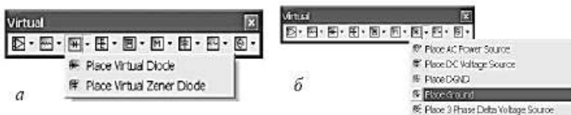
Рисунок 6.83 – Панель віртуальних елементів (а) та розташування елемента корпус (б)
