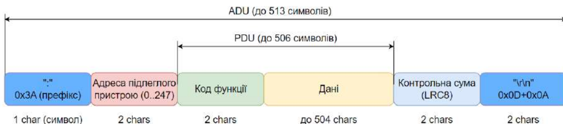
Рисунок 3.7 – Структура пакета даних в Modbus ASCII
