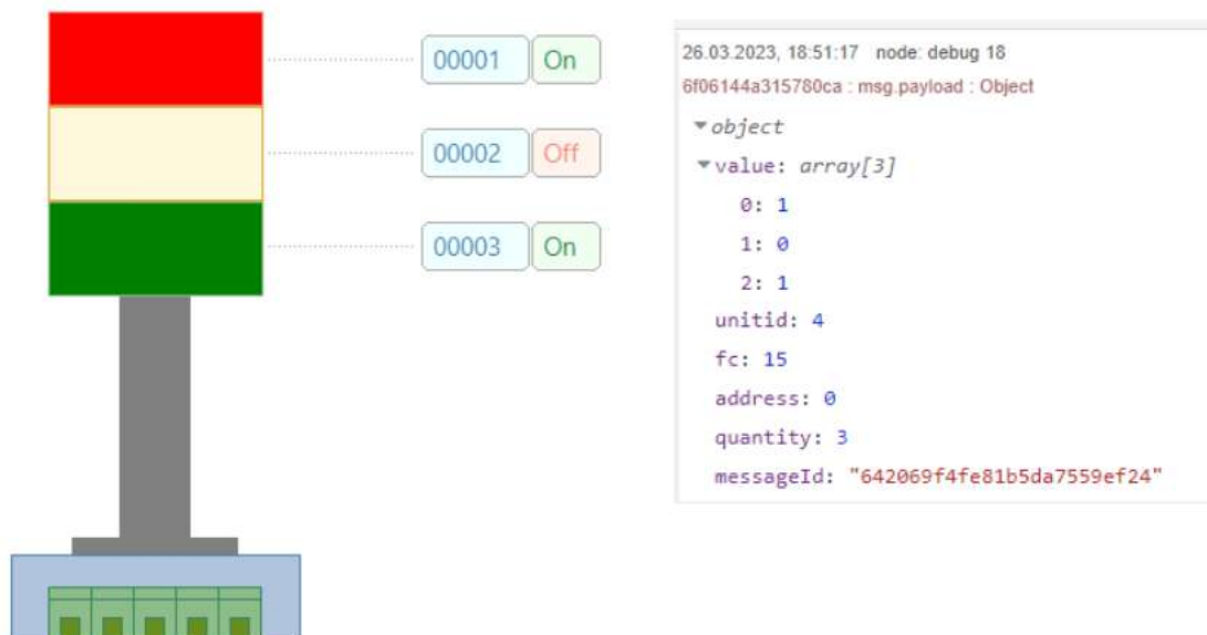
Рисунок 3.58 – Результат виконання функції увімкнення червоного та зеленого сегментів світлофора і протокол роботи вузла Modbus-Flex-Write
