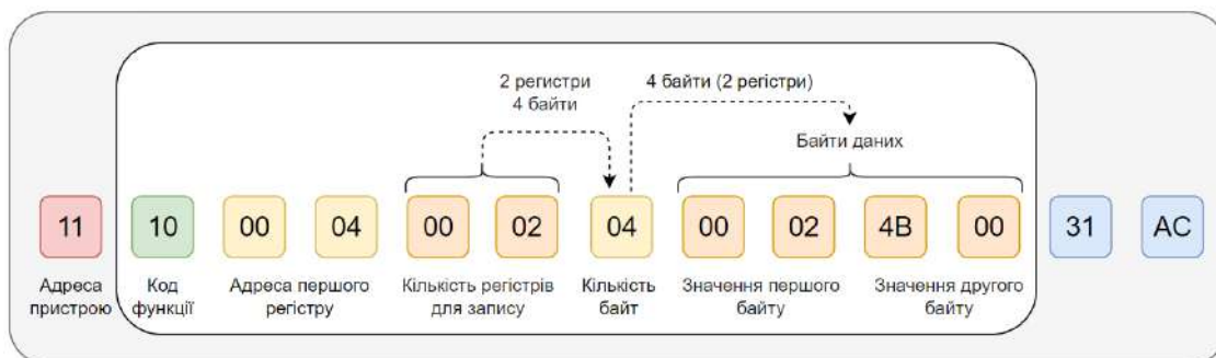
Рисунок 3.20 – Приклад запита для зміни режиму роботи та швидкості передавання даних
