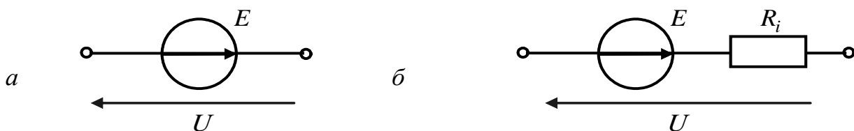
Рисунок 1.2 – Джерела напруги: a – ідеальне; б – реальне
