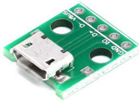
Рисунок 4.34 – Роз'єм адаптера Micro USB
