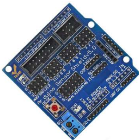
Рисунок 4.22 – Палата розширення Arduino Uno R3 Sensor Shield V5.0
