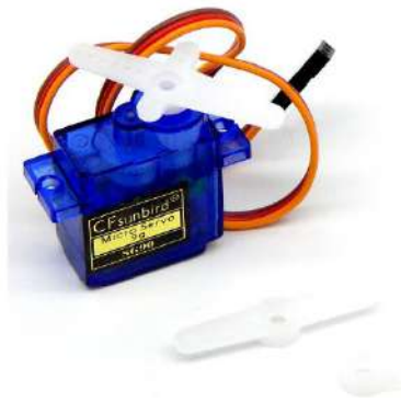
Рисунок 4.33– Мікро сервопривід SG90
