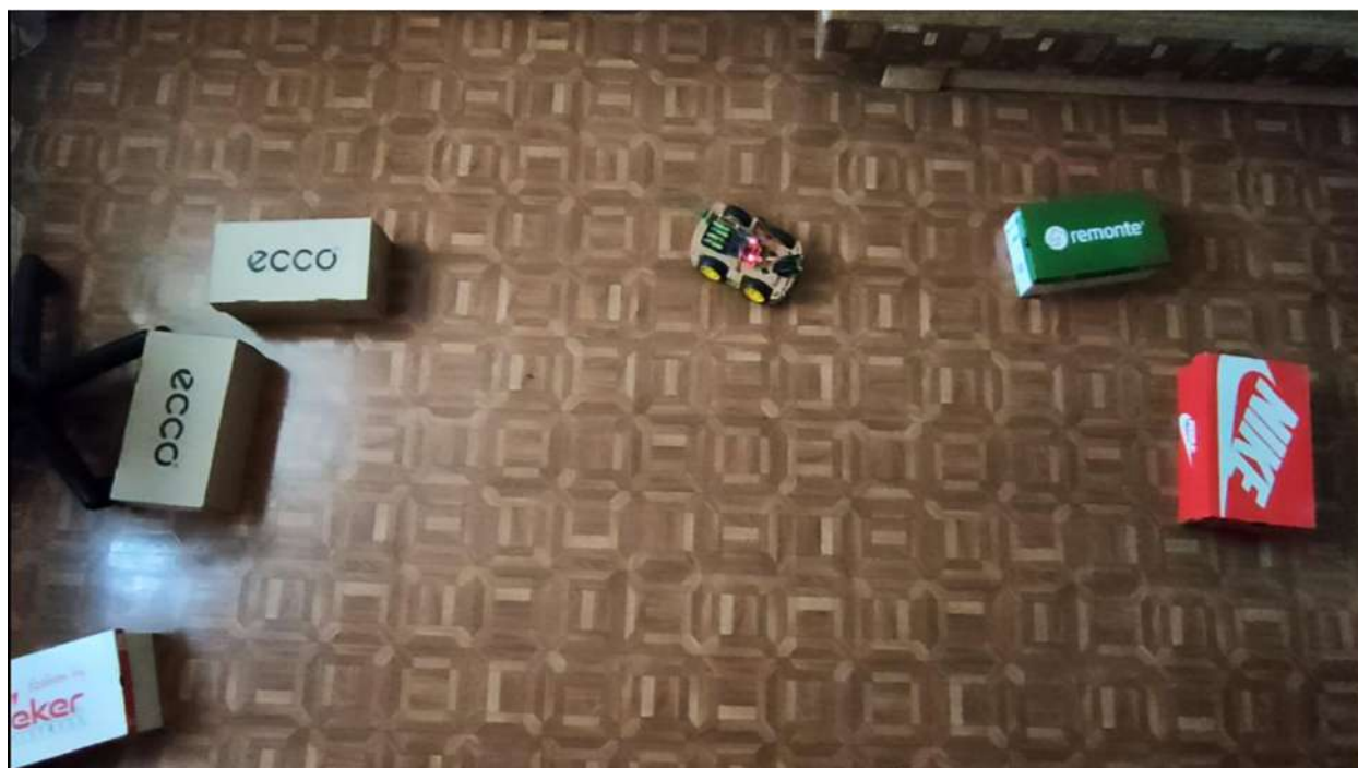
Рисунок 4.104 – Робот наблизився до перешкоди на 60 сантиметрів
