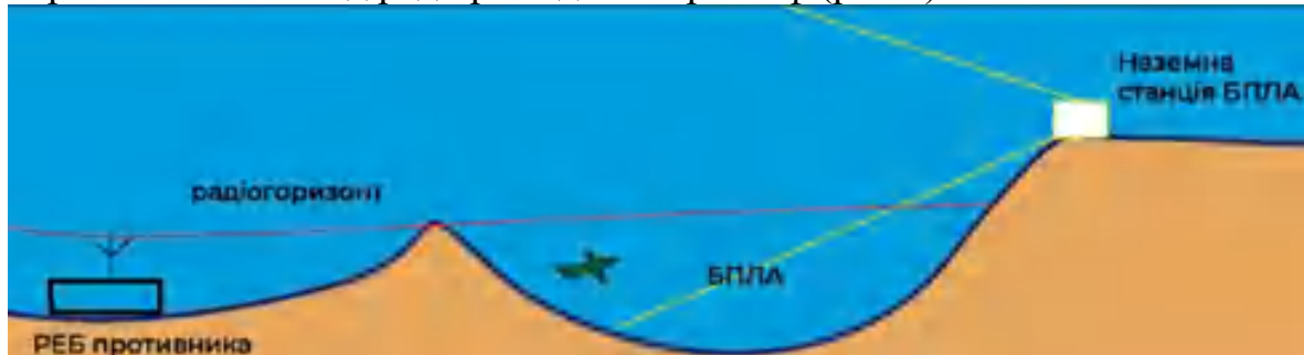
Рис.1. Використання природного укриття та рельєфу місцевості для забезпечення скритності каналів керування БПЛА
