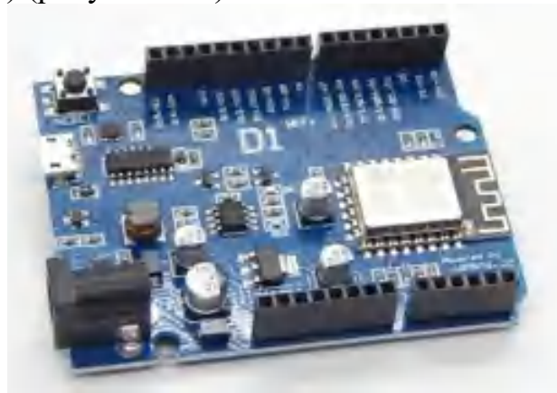
Рисунок 1.1. - Плата Arduino с WiFi модулем ESP8266 (WeMos D1)
