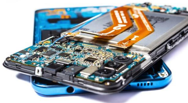
Рисунок 1 – Приклад технології HDI в сучасному смартфоні
