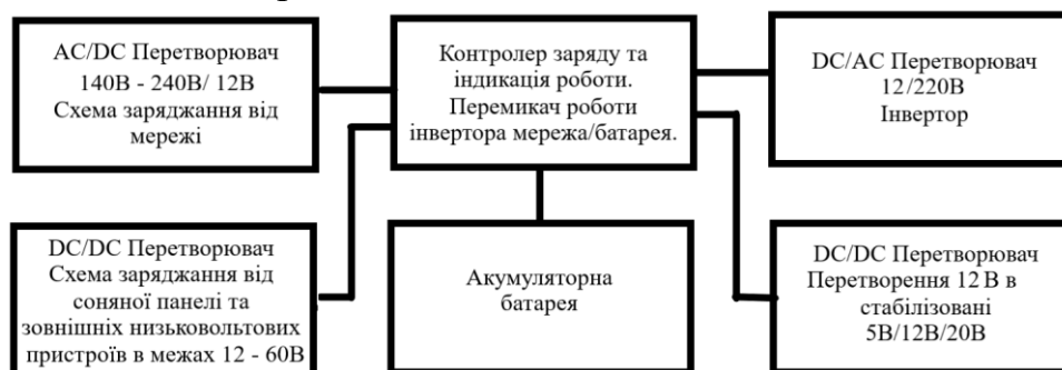
Рисунок 1 – Принципова блок схема автономного безперебійного джерела живлення
