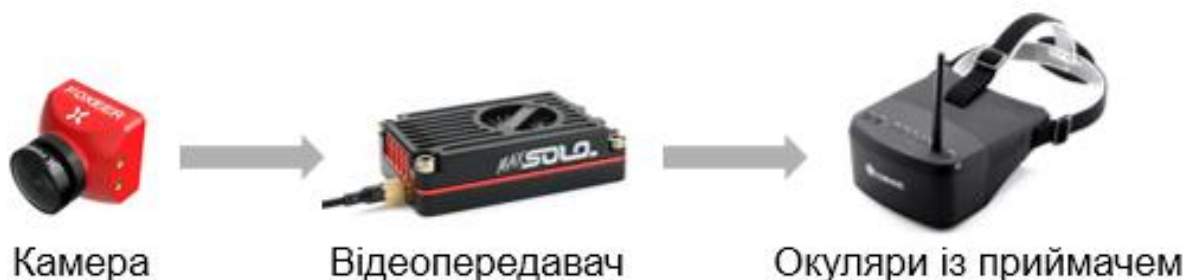
Рисунок 1 – Будова системи передачі відео від камери до оператора FPV дрона
