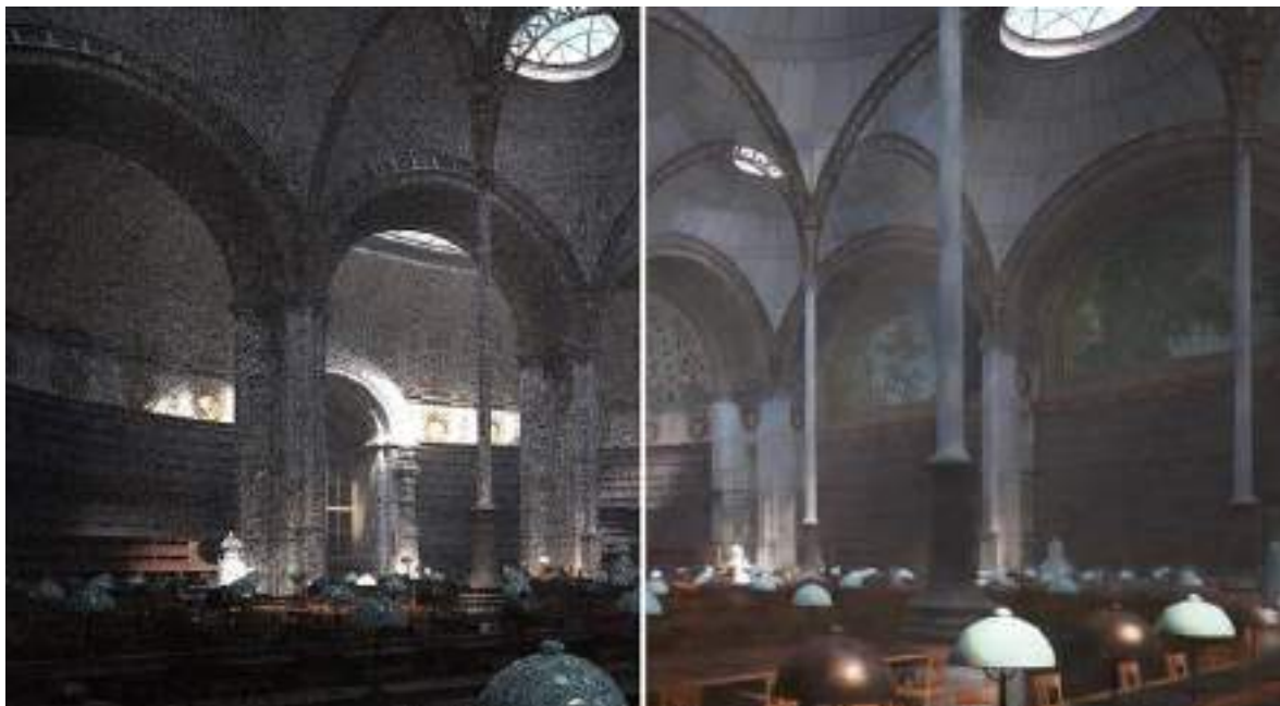
Рисунок 1 – Усунення шуму з використанням штучного інтелекту (OptiX) [1]
