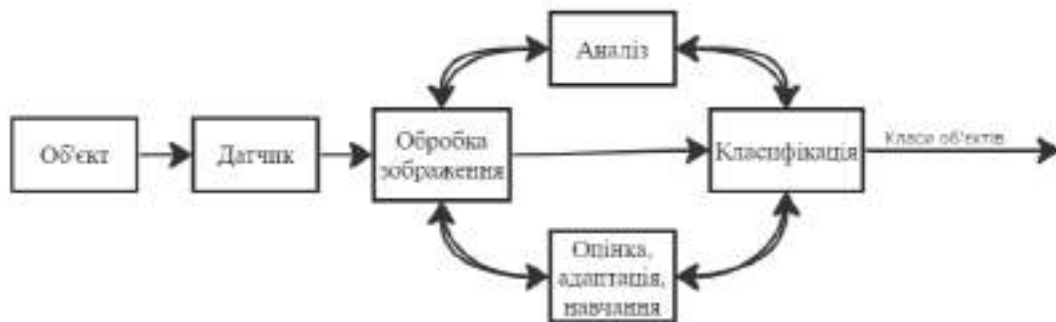
Рисунок 1 – Процес розпізнавання образів
