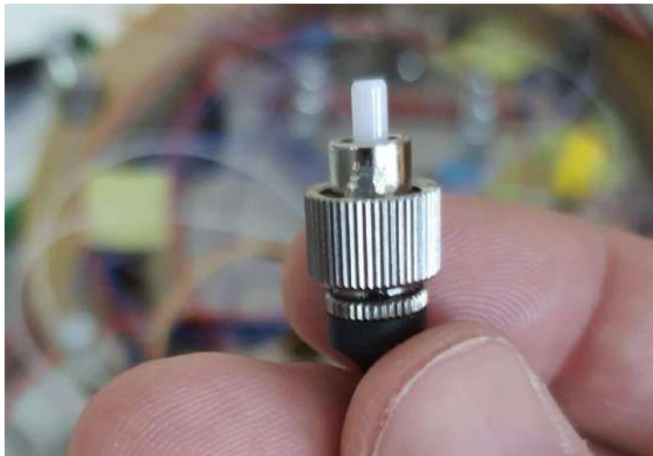
Рисунок 5.16 – Зображення оптичного конектора зі зпиляним ключем
