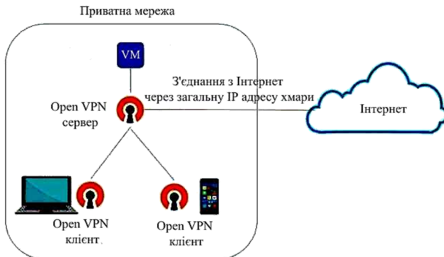
Рисунок 1 – Схема підключення користувачів через VPN-сервер до захищеного сегменту корпоративної комп'ютерної мережі
