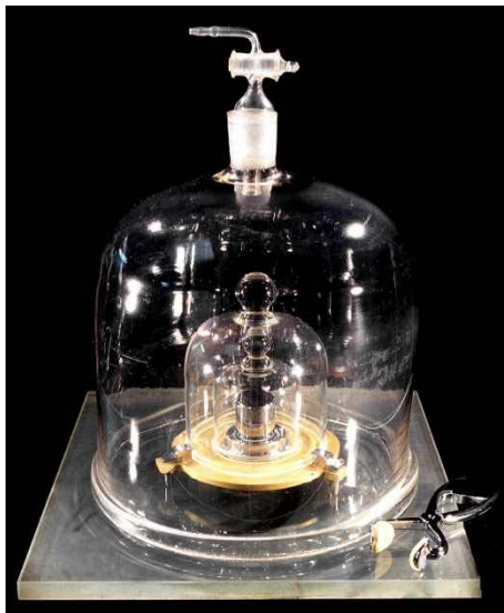
Рис. 4.18. Прототип кілограма, що зберігається в Архіві Франції
