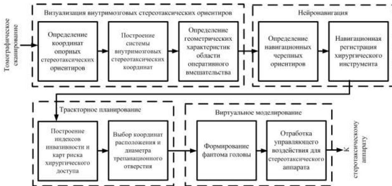
Рисунок 2.40 – Структурна схема модифікованого методу комп'ютерного планування стереотаксичних втручань
