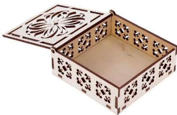
Рисунок 4 – Пакування з дерево-волокнистих матеріалів, виготовлене лазерним розрізуванням: а – фанера; б – ХДФ
