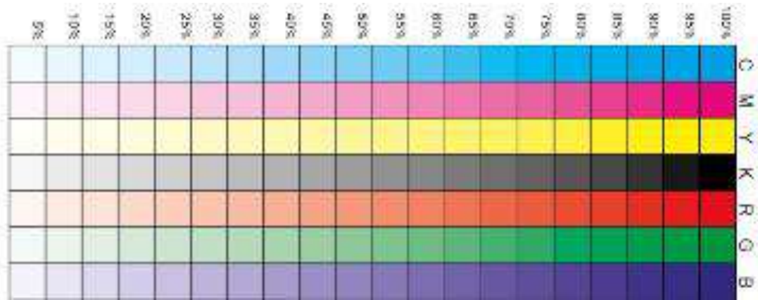
Рисунок 3.5 – Тест-об'єкт для визначення показника «Градаційна передача»
