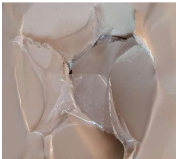
Рисунок 8 – Зразки ламінованого картону після досліджень на продавлювання: 1 – Alaska White – 275 г/м 2 ; 2 – Alaska White – 215 г/м 2
