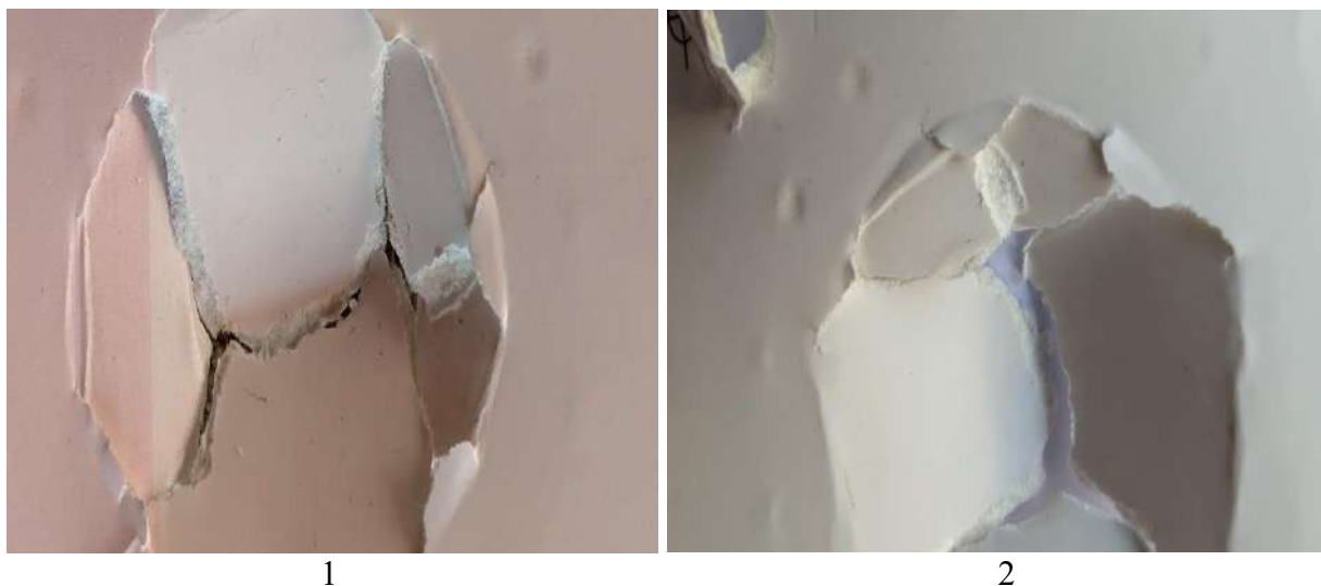
Рисунок 10 – Зразки лакованого картону після досліджень на продавлювання: 1 – Alaska White – 275 г/м 2 ; 2 – Alaska White – 215 г/м 2
