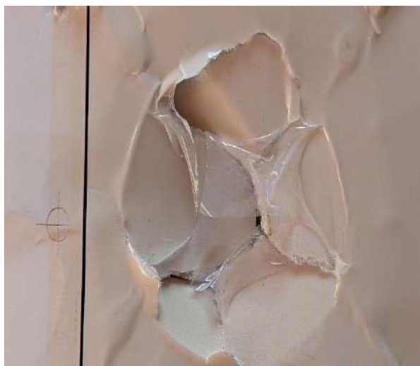
Рисунок 8 – Зразки ламінованого картону після досліджень на продавлювання: 1 – Alaska White – 275 г/м 2 ; 2 – Alaska White – 215 г/м 2
