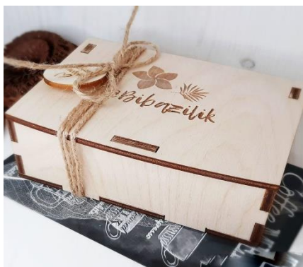
Рисунок 5 – Пакування з дерево-волокнистих матеріалів, де виготовлення кришки здійснене лазерним гравіюванням: а – фанера; б – ХДФ
