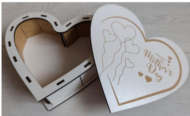
Рисунок 5 – Пакування з дерево-волокнистих матеріалів, де виготовлення кришки здійснене лазерним гравіюванням: а – фанера; б – ХДФ
