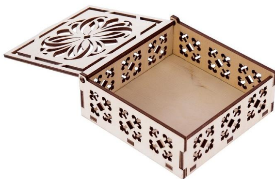
Рисунок 4 – Пакування з дерево-волокнистих матеріалів, виготовлене лазерним розрізуванням: а – фанера; б – ХДФ
