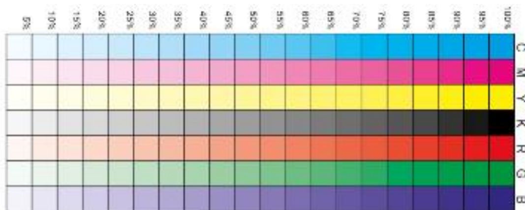
Рисунок 3.5 – Тест-об'єкт для визначення показника «Градаційна передача»
