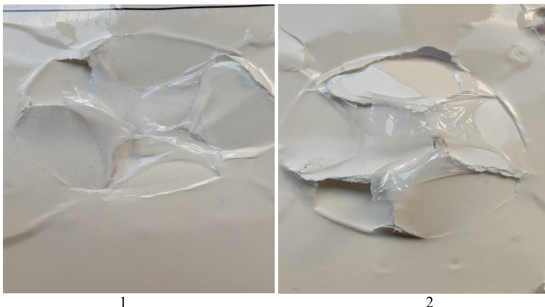
Рисунок 9 – Зразки ламінованого картону після досліджень на продавлювання: 1 – SinarVanda GC1 – 245 г/м 2 ; 2 – SinarVanda GC1 – 280 г/м 2
