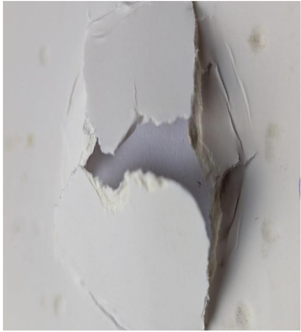
Рисунок 7 – Зразки картону після досліджень на продавлювання: 1 – SinarVanda GC1 – 245 г/м 2 ; 2 – SinarVanda GC1 – 280 г/м 2
