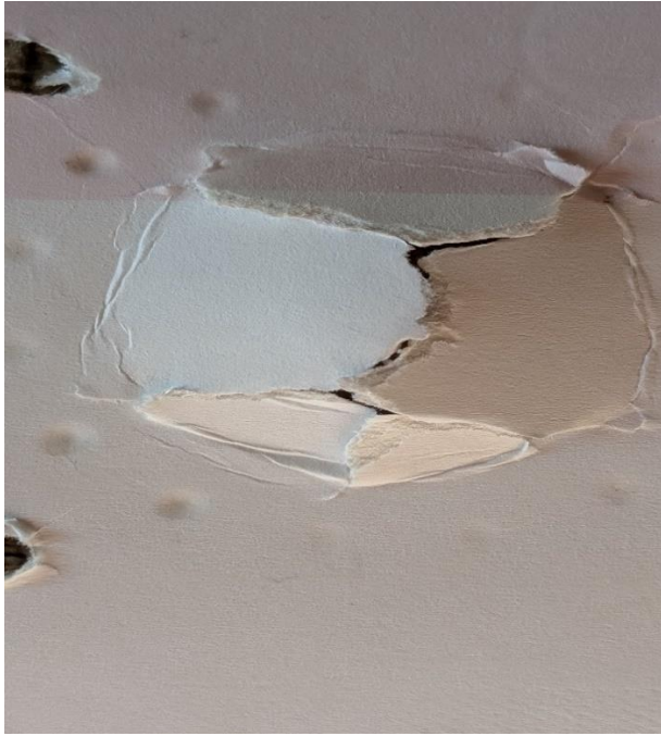
Рисунок 7 – Зразки картону після досліджень на продавлювання: 1 – SinarVanda GC1 – 245 г/м 2 ; 2 – SinarVanda GC1 – 280 г/м 2
