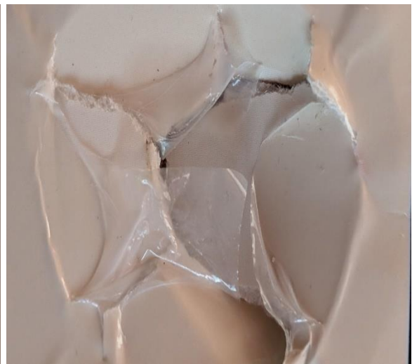
Рисунок 7 – Зразки картону після досліджень на продавлювання: 1 – SinarVanda GC1 – 245 г/м 2 ; 2 – SinarVanda GC1 – 280 г/м 2
