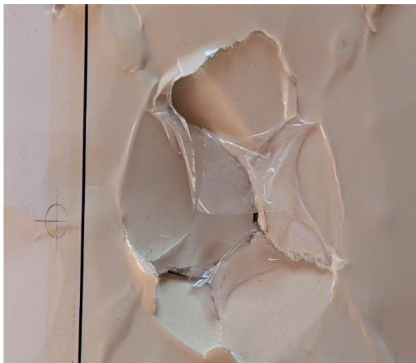
Рисунок 7 – Зразки картону після досліджень на продавлювання: 1 – SinarVanda GC1 – 245 г/м 2 ; 2 – SinarVanda GC1 – 280 г/м 2
