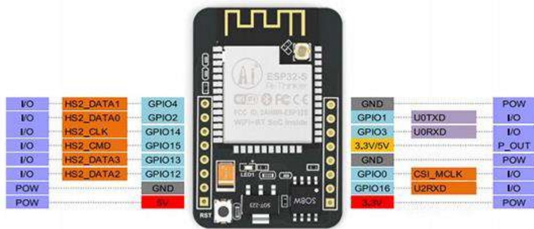
Рисунок 1.7 - Загальний вид та призначення пінів шини GPIO на модулі ESP32-Cam [26]
