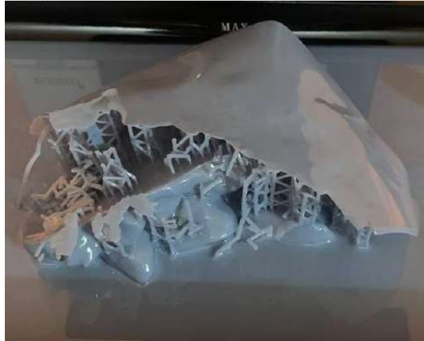
Рисунок 1.55 – Відшарування базових шарів від платформи
