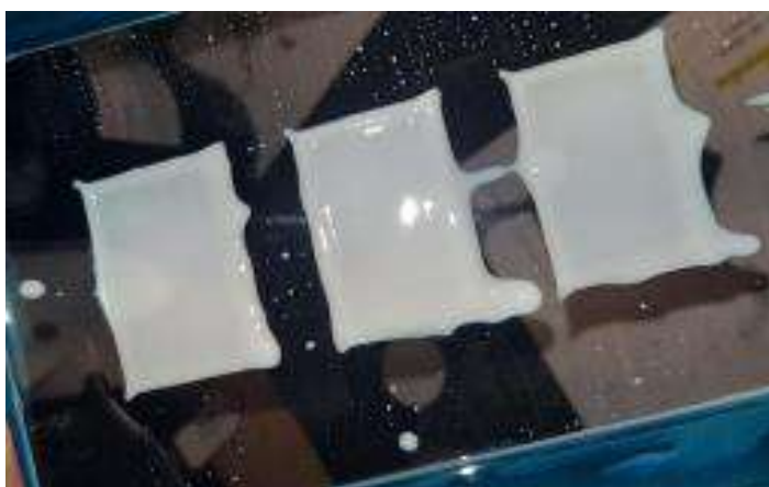
Рисунок 1.58 – Залишки моделі на плівці
