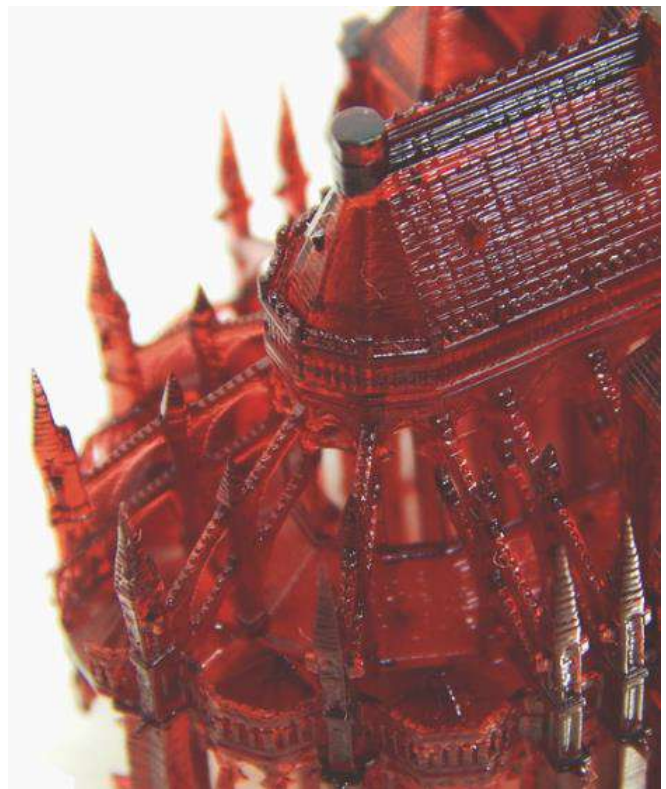
Рисунок 1.22 – Порівняння надрукованих деталей з використанням екранів з розміром пікселя 100 мкм і 45 мкм
