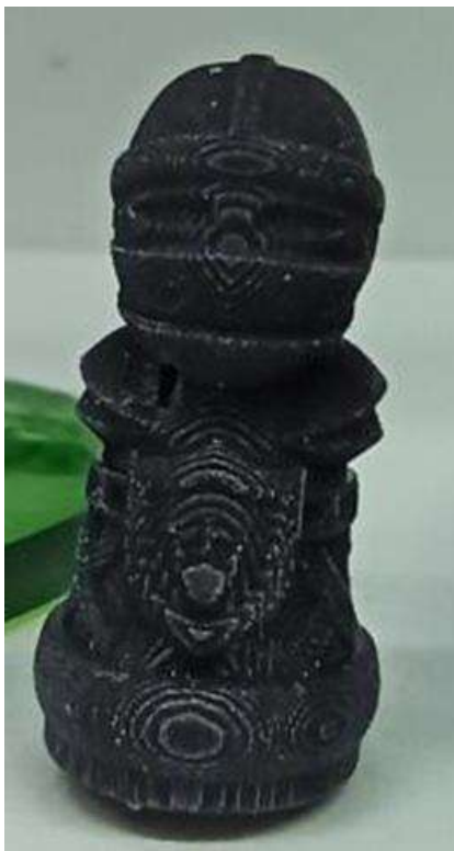
Рисунок 1.22 – Порівняння надрукованих деталей з використанням екранів з розміром пікселя 100 мкм і 45 мкм
