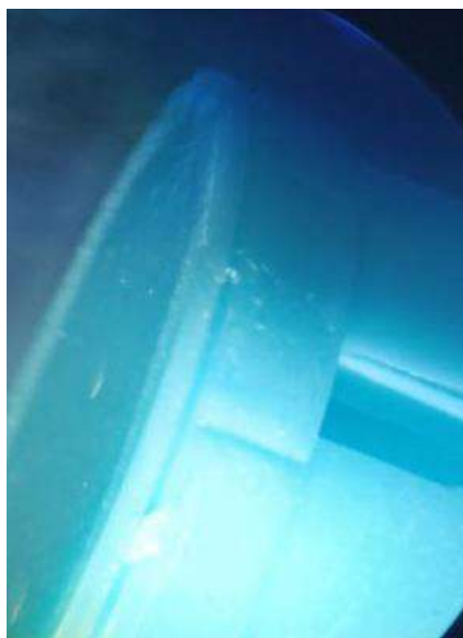
Рисунок 1.54 – Розшарування між базовими та звичайними шарами
