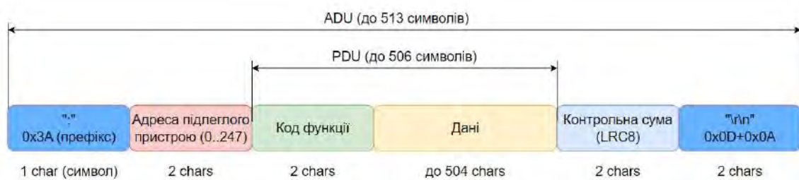
Рисунок 4.7 – Структура пакета даних в Modbus ASCII
