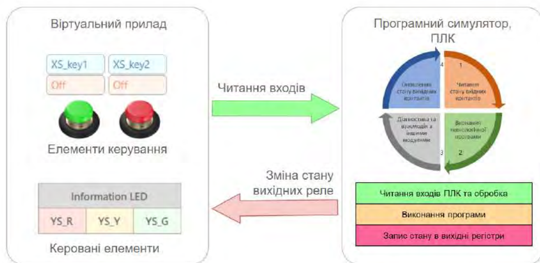
Рисунок 1.21 – Принцип взаємодії віртуального приладу і програмного симулятора ПЛК
