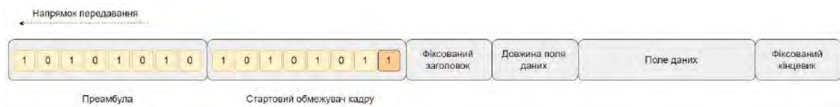
Рисунок 2.11 – Приклад реалізації методу передачі зі встановленням з'єднання
