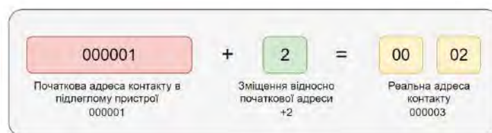
Рисунок 5.16 – Принцип формування адреси в програмі ModRSsim2
