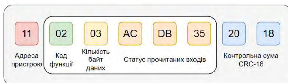
Рисунок 4.12 – Приклад відповіді на запит читання дискретних входів
