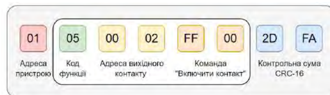
Рисунок 5.15 – Запит до підлеглого пристрою для увімкнення вихідного контакту 0x0002
