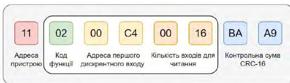
Рисунок 4.11 – Приклад запиту для читання дискретних входів 10197-10204
