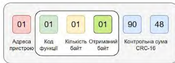
Рисунок 5.20 – Отримана відповідь про стан вихідного контакту 000003
