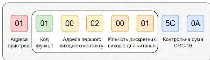
Рисунок 5.18 – Запит для перевірки стану вихідного контакту з адресою 000003
