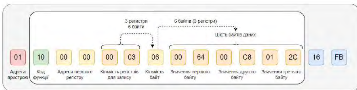
Рисунок 5.22 – Приклад запиту для запису значення в три регістри зберігання
