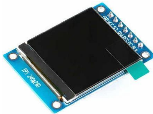
Рисунок 4.75 – TFT-дисплей типу IPS 240x240
