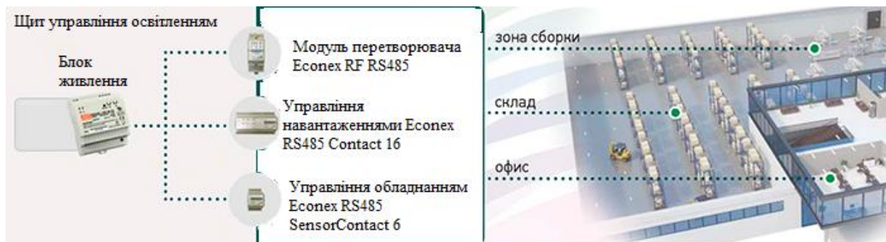
Рисунок 4.7 – Управління освітленням на основі RF RS485 і RS485 Contact 16
