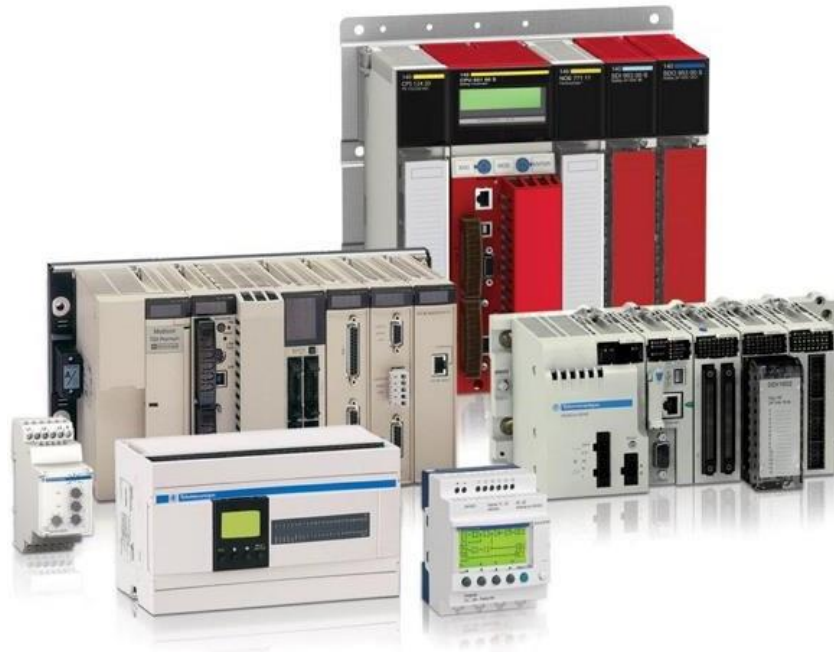
Рисунок 4.9 – Програмовані логічні контролери з розширеними можливостями
