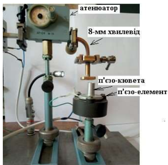
Рис. 1. Робочий вузол апаратурно-реєструючого комплексу для вимірювання діелектричної проникності суспензії еритроцитів
